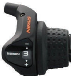
Przerzutka A – zmieniamy gdy nie kręcimy pedałami(korbą)
